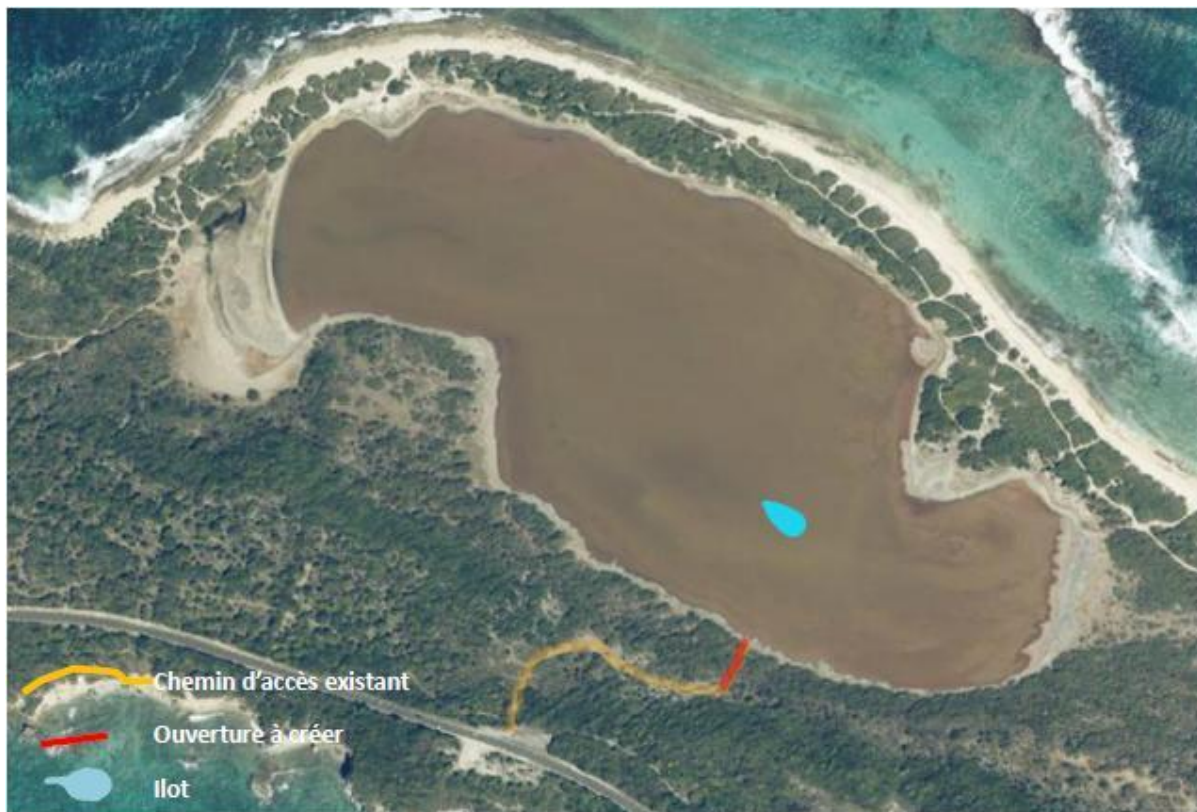
Figure 14 : Schéma de principe pour la réalisation de l'îlot artificiel
